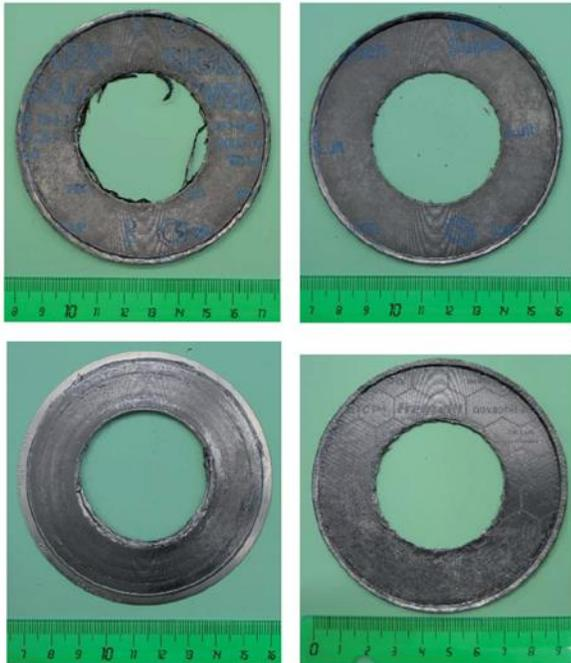
Graphitdichtungen trocken eingebaut
