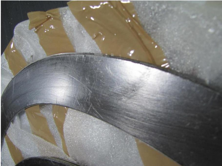
Kratzer auf der Oberfläche sichtbar, aber und fühlbar:
